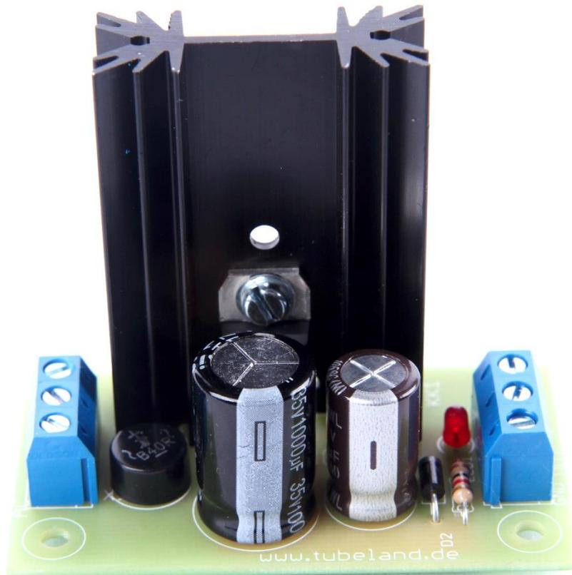
Ein Kleines aber gutes Stabelesiertes Netzteil ist mit einem Festspannungsregler der 78xx Familie Sehr einfach zu realisieren.
