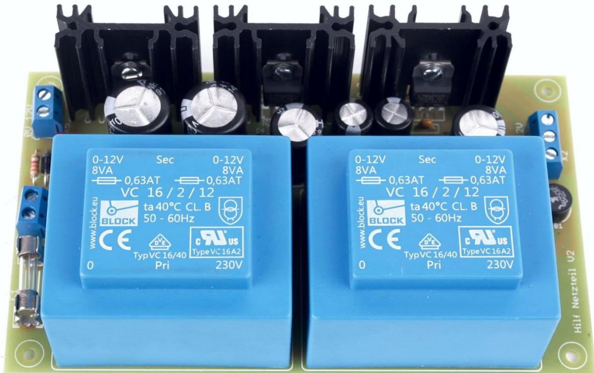
Für die Tubeland-[Schutzeinrichtungen](#) der Leistungsendstufen wird mehr als eine Spannung benötigt. Dieses Netzteil liefert +/- 12 VDC für die Lautsprecherschutzschaltung sowie + 12 VDC und ggf. + 24 VDC, je nach Lüfter, für die Lüftersteuerung. Entsprechend muss der Trafo Tr2, C9, C10 und der Festspannungsregler IC 3 angepasst werden.
