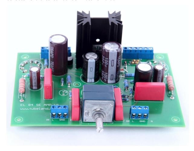
Um die Spannungsversorgung direkt an Bord zu haben, wurde das Netzteil, samt seiner bewährten DC-Stabilisierung, auf der Leiterplatte integriert und versorgt beide Kanäle. Die Arbeitsspannung wird über D2-D4 eingestellt.
